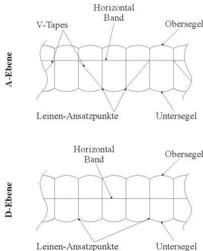
Abbildung 1: Honeycomb-V-Tape System des UP Summit 2
