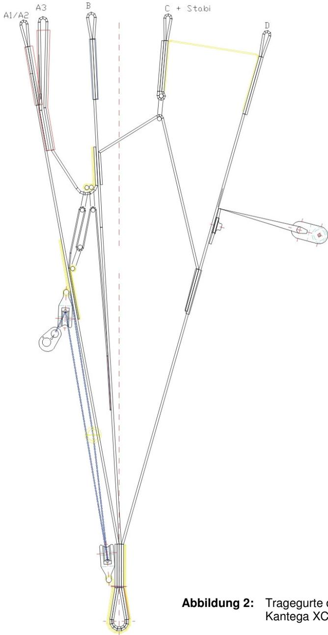
**Abbildung 2:** Tragegurte des UP Kantega XC
