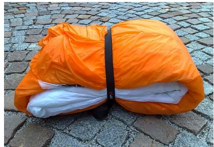
Die Eintrittskante mit dem ASS sollte außen liegen, wie im oberen Bild erkennbar. Fixieren Sie dann das Bündel mit dem Kompressionsband.
