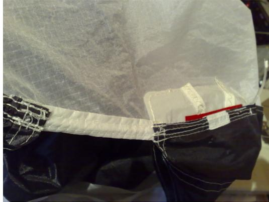
Bevor das Ende des Drahtes in der Tasche fixiert wird, sollte es mit einem Klebestreifen abgedeckt werden, damit keine scharfen Kanten oder Ecken das Tuch beschädigen.
